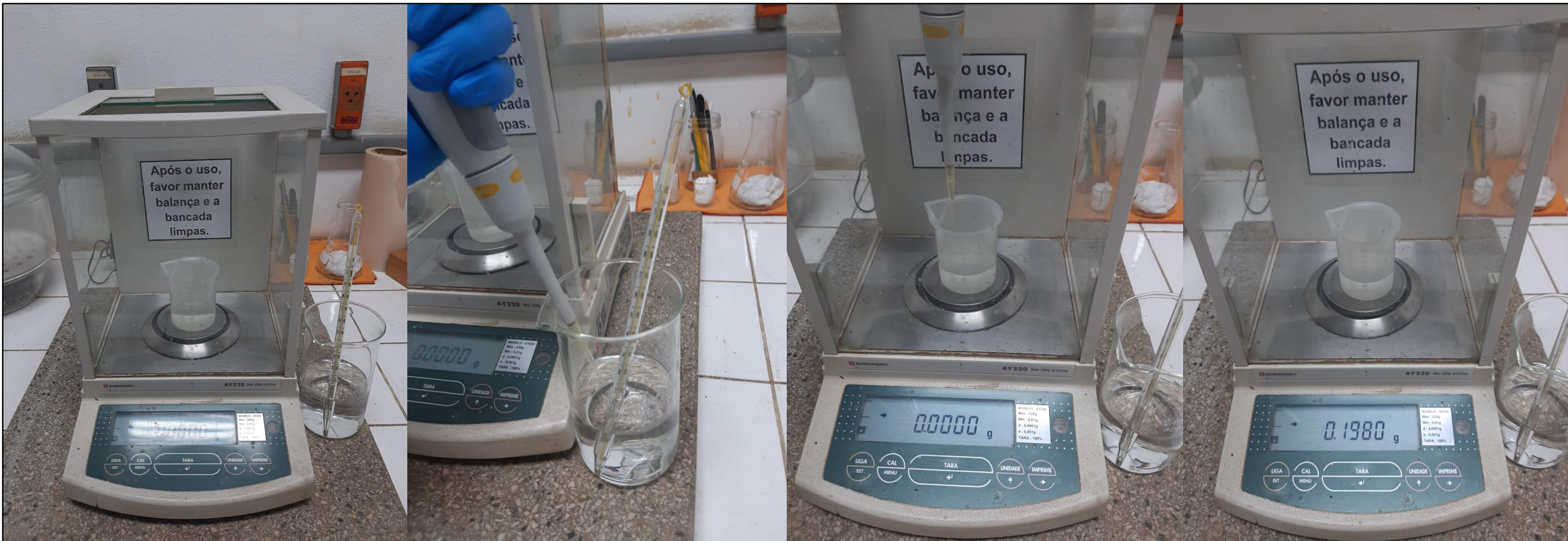
Figura 2: Sequência de verificação de Micropipetas
