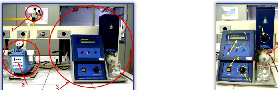
Figura 3. Detalhamento de um fotômetro de chama. À esquerda: 1- conexão dos sistemas do gás combustível; 2- ar comprimido (comburente); 3- corpo de fotômetro. À direita: A- módulo de controle; B- botão Liga/Desliga; C- Controle de vazão do combustível; D- sistema de nebulização; E- sistema Queimador/Detector.
