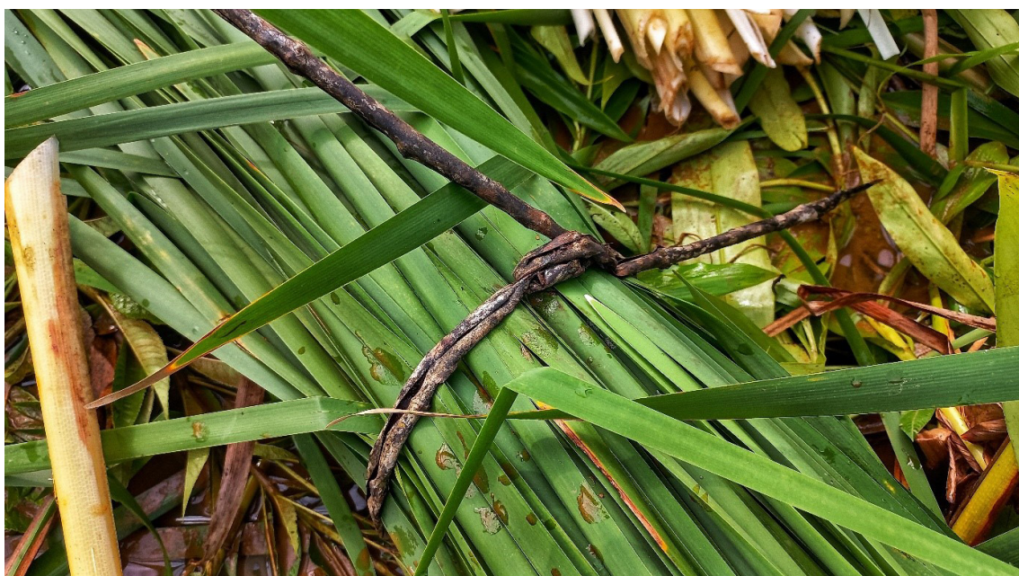
Fotografia 11 – Detalhe da amarração de um feixe de taboa com cipó imbé. Fonte: Acervo pessoal, 2023.
