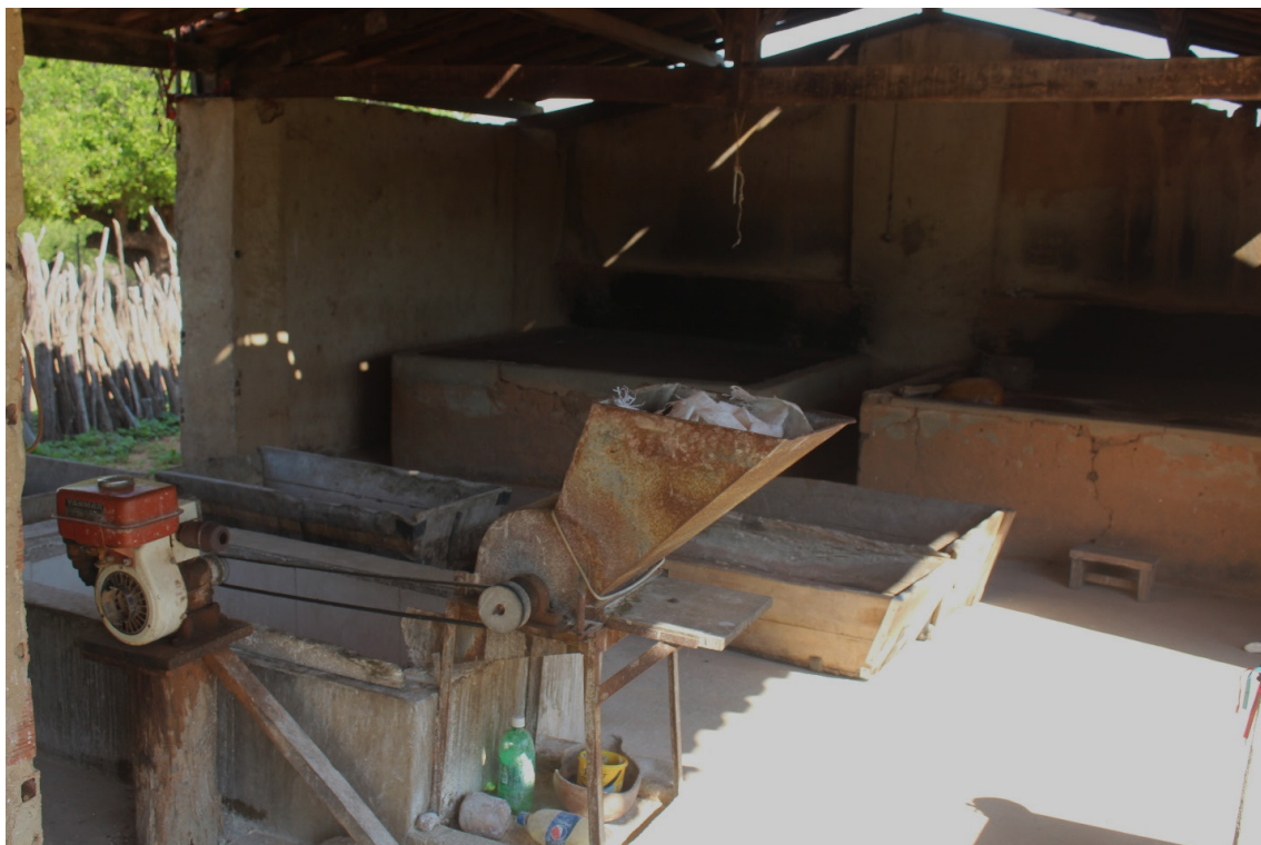
Fotografia 3 – Vista interna da casa de farinha comunitária de Lagoa de Fora. Em primeiro plano, a máquina de moer as raízes de mandioca, onde elas são processadas e despejadas na cocha de cimento coberta por cerâmica na cor branca, sendo manipulada seguidamente pelas pessoas que ocupam e dinamizam esse espaço. Ao fundo, os dois fornos a lenha da casa de farinha, esses produzidos e erguidos em tijolos de barro e cobertos por uma camada de reboco em barro, tendo como parte superior uma placa de metal. Fotografia: Nailton Negreiros Ribeiro, 2023.
