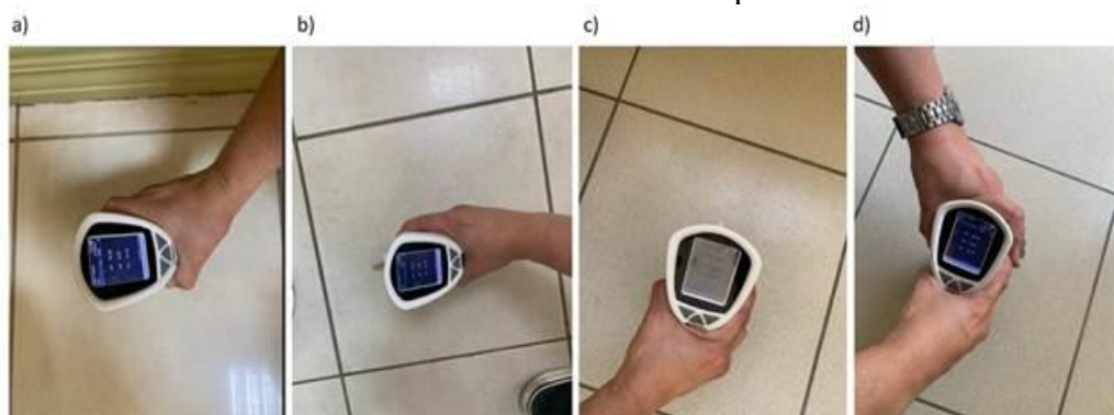
FIGURA 14 – Testes com o colorímetro nos porcelanatos do TJPA
