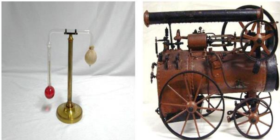
FIGURA 3 – Materiais de Laboratório (Higrômetro de condensação utilizado para determinar a umidade a partir da temperatura de condensação/ Modelo de locomotiva à vapor)
